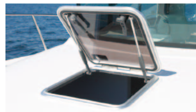
Skylight hatch (Berth)
